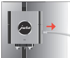
Wenn zu wenig Schaum beim Aufschäumen von Milch entsteht oder Milch aus dem Kombiauslauf spritzt, kann dieser verschmutzt sein. Zerlegen und spülen Sie in diesem Fall den Kombiauslauf.
